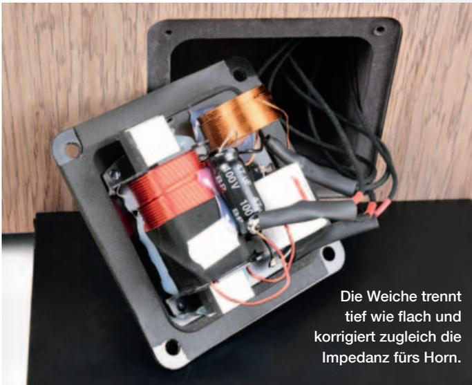
Die Weiche trennt tief wie flach und korrigiert zugleich die Impedanz fürs Horn.
