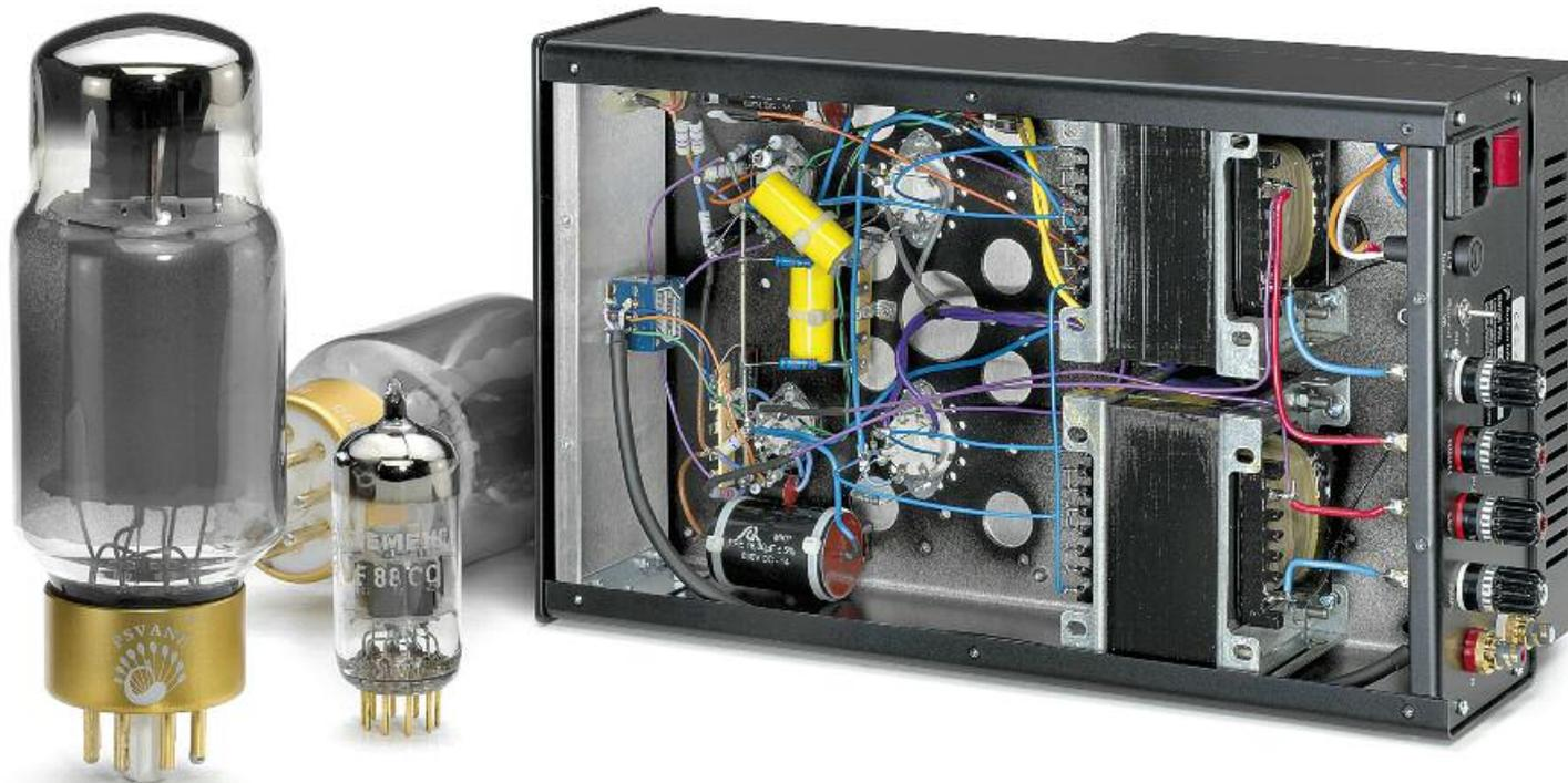
Sauber aufgebaut – in diesem Fall frei verdrahtet – mit guten Bauteilen und hausgemachten Übertragern. Man kann – Hersteller und Verkäufer dürfen das wegen gesetzlicher Bestimmungen nicht – den Klang mit NOS-Röhren noch deutlich „pimpfen“
