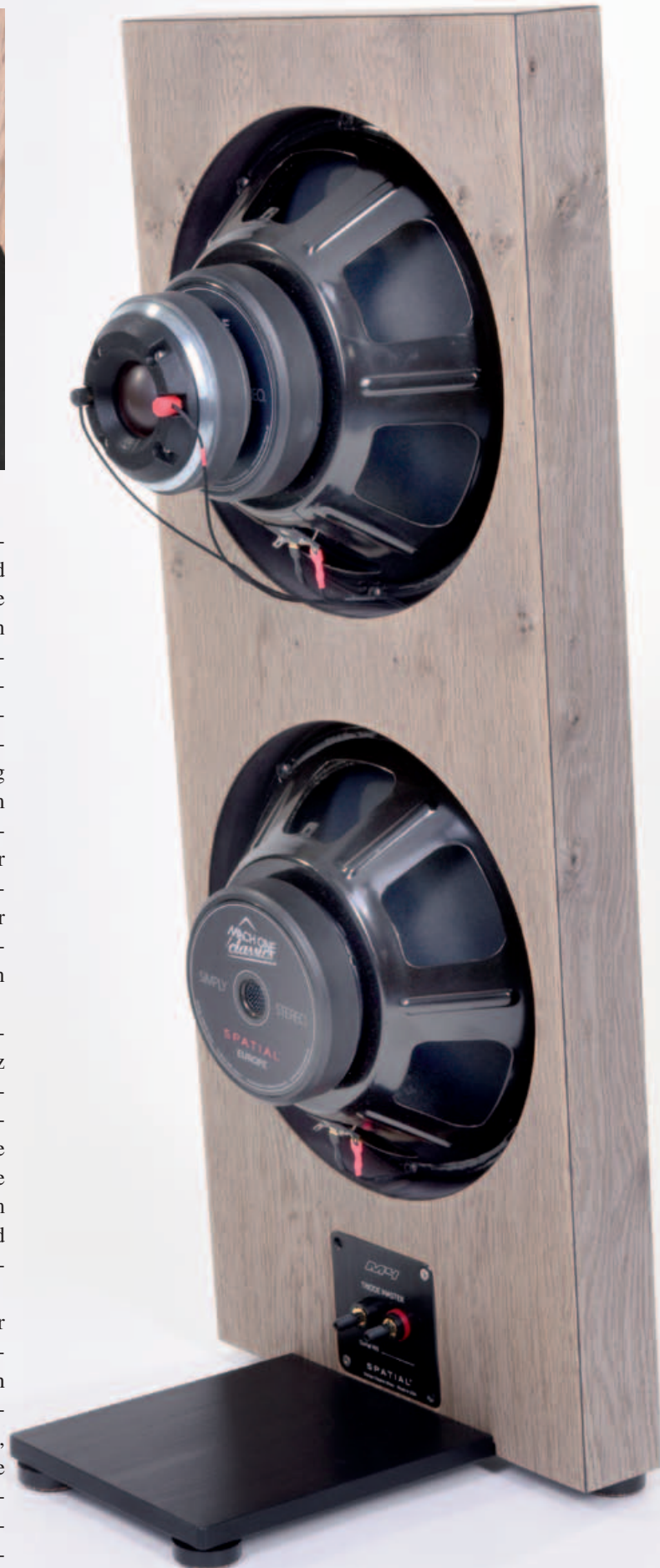
Die Weiche trennt tief wie flach und korrigiert zugleich die Impedanz fürs Horn.
